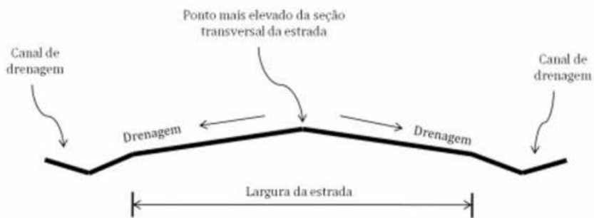
Figura 46: Perfil transversal de uma estrada com superfície abaulada Fonte: Silva, 2011
